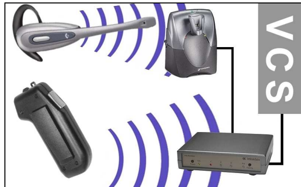
Funktionsweise der IFB-REVARIO in Verbindung mit VCS
